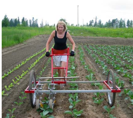
Weed Master är en skjutbar redskapsbärare som kan användas med olika redskap.
