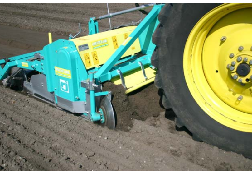
Ortiflor-Stones är en bäddläggare för steniga jordar. (Foto: RJ Maskiner)
