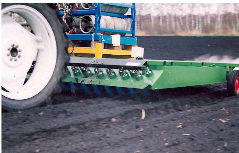
Envo-Dan flamaggregat för bredflamning i stora odlingar. Redskapet har gasoluttag i vätskefas från liggande gasolflaskor. (Foto: Bill Alsted)
