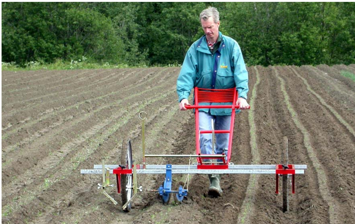
Tallriksskären på Weed Master kan användas till den första mekaniska radrensningen i sådda grödor.
